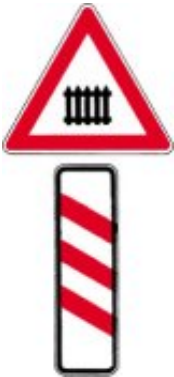
dreistreifige Bake dreistreifige Bake (links) - vor beschränktem Bahnübergang -
